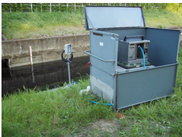
Figura 33 – Autocampionatore installato sul T. Seveso
