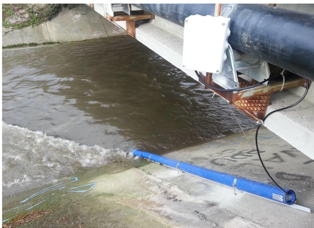
Figura 29 – Installazione della sonda S/N 13M101704 all'interno del CSNO
